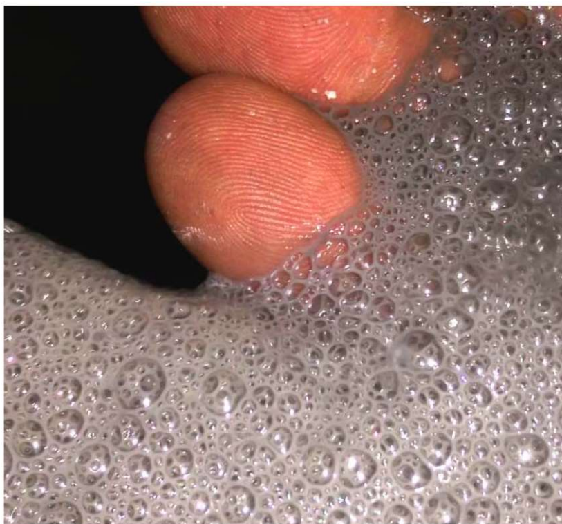
Рис. 5. Мелко-дисперсный пузырьёк при дофлотации камерного продукта золотосодержащей руды
