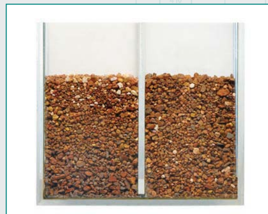
железная руда после | до отсадки
